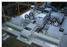
架線検測装置
