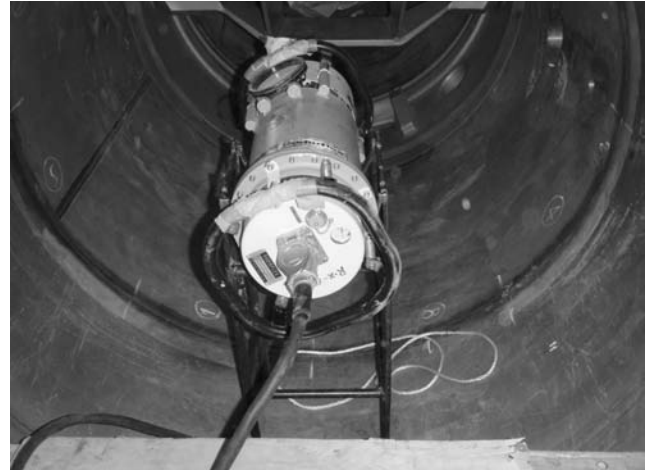
第19図 UT検査状況
