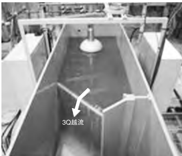
第6図 試験水槽 水槽内には幹線流下路と越流せきを有し、流量が3Qを超えた場合にせきを越流する3Q越流が模擬できる。
