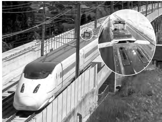
第21図 CATENARY EYEが搭載された九州新幹線
