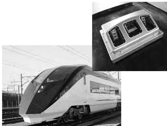
第23図 新型スカイライナーと電車線監視装置（屋根上）
