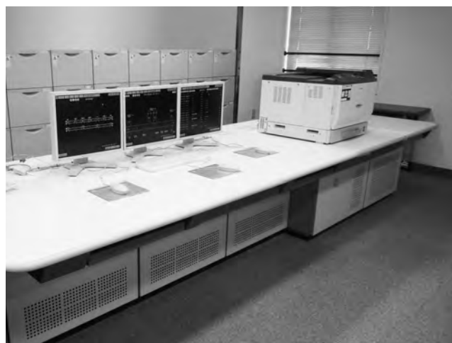
第20図 SCADAシステム
