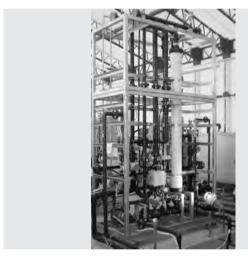
第5図 実証実験用膜ろ過装置
