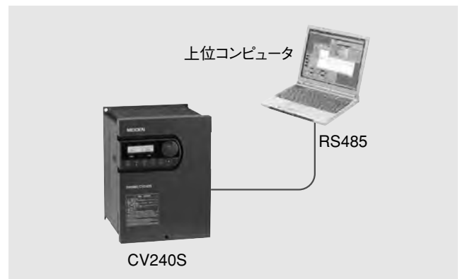
第6図 上位コンピュータとCV240Sの接続例
