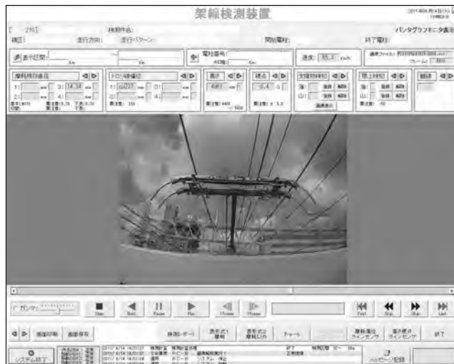
第7図 パンタグラフ周辺モニタ画像 パンタグラフ周辺モニタ画像を検測結果と共に表示・再生する。
