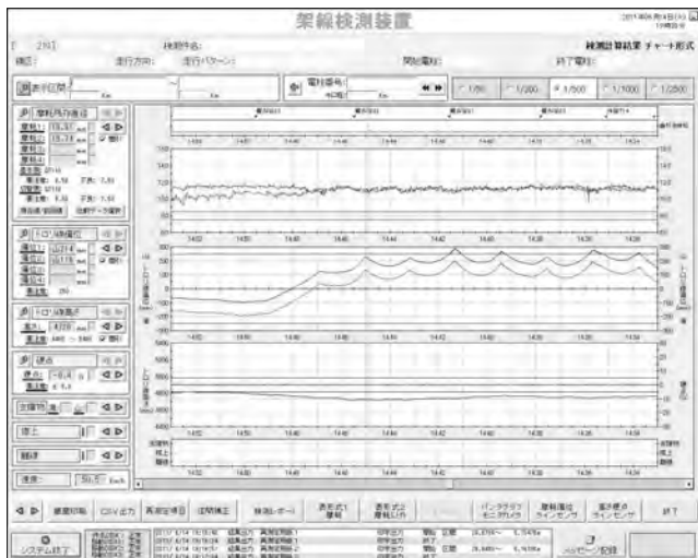
第6図 チャート形式集計画面 検測結果をチャート形式に集計して表示すると共に指定箇所の測定結果を数値で表示する。
