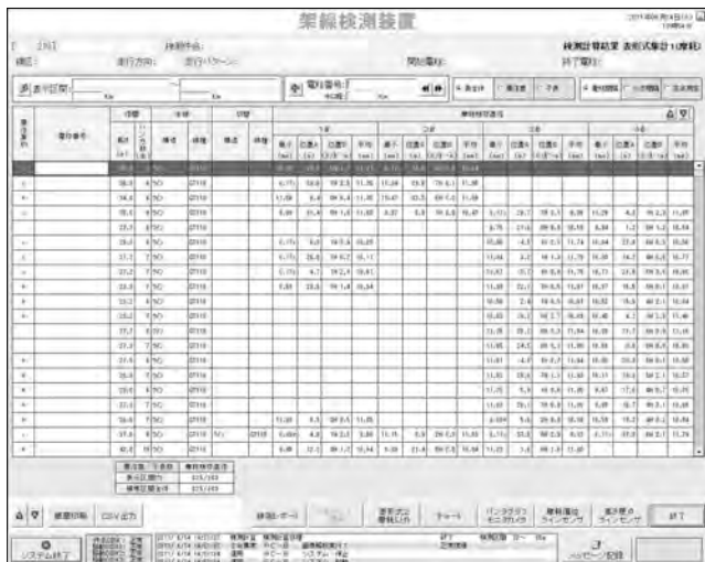
第5図 表形式集計画面 (例：摩耗) 各検測項目に特化した集計方法で検測結果を表形式に集計して表示する。
