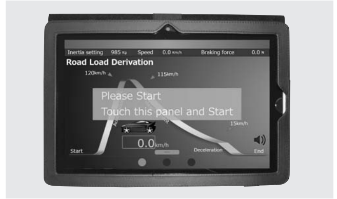
第9図 スレートPC適用例3 (修正検証用アプリケーション) ドライバーが試験車両に持ち込んで使用することを考慮し、STARTボタンを押しやすく、現在状態を見やすくしている。また音声出力により、画面を見なくても現在状態が分かる。
