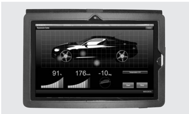
第8図 スレートPC適用例2 (現在値表示用アプリケーション) 現在値表示に特化し、スロットル開度・車速・勾配の現在値を直感的に認識できる。
