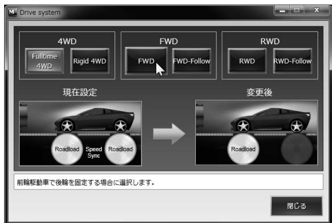
第5図 操作した後の状態を表示 ボタンの上にマウスカーソルを乗せると、そのボタンを押した場合に切り替わる駆動方式が絵で表示される。操作した結果どうなるかを直感的に認識できる。
