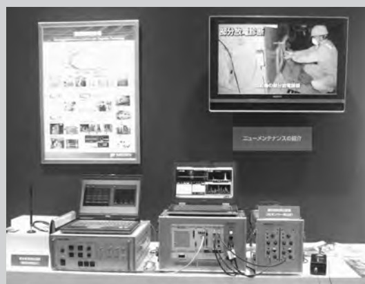
部分放電測定装置 (左：電磁波検出法，右：超音波検出法)
