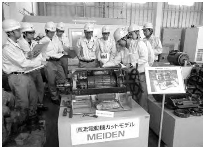
第3図 回転機教育 回転機のカットモデルを利用して構造説明する。
