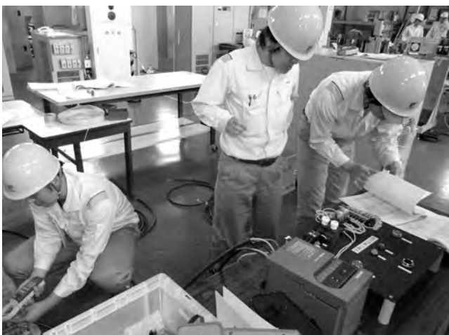
第6図 可変速装置教育 インバータなど可変速装置について実機を用いて基礎から学ぶ。
