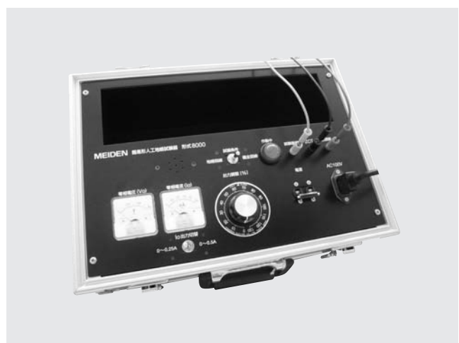
第2図 人工地絡試験器
