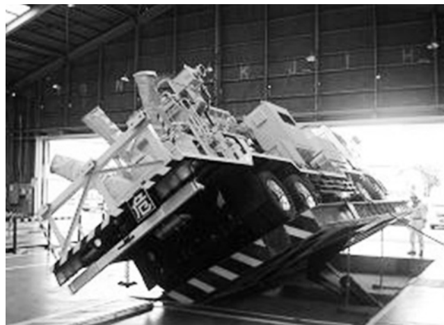
第1図 移動変の転倒角測定状況 実際に製作した移動用変圧器を車両ごと30度傾けて、転倒しないか確認している状況を示す。
