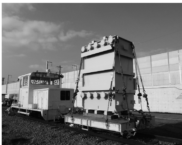
第8図 保守用車へのAT積載状況
