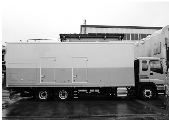
第13図 1000kVA 発電機車
