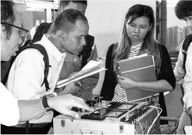
第11図 保護継電器試験
