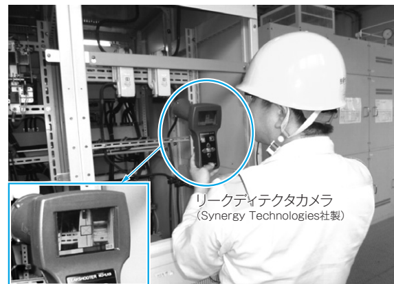
(b) カメラ付きコロナ検出器による診断風景
