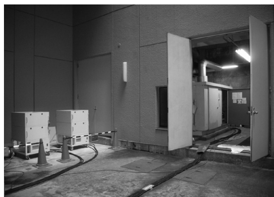
第8図 模擬負荷試験実施状況
