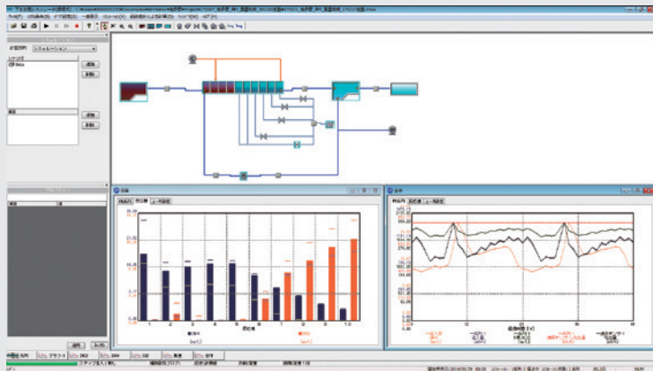
リアルタイム硝化制御コントローラ画面
