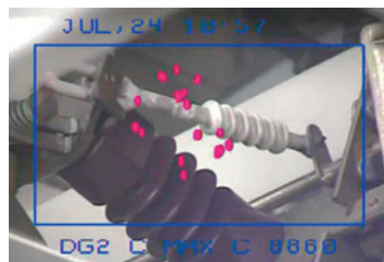
紫外線カメラによる診断
