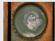
腐食したリレー接点
