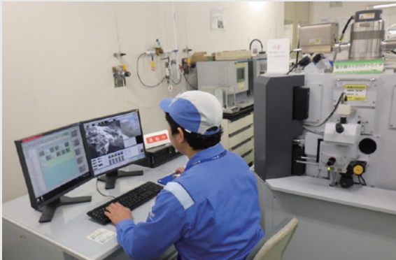
電子マイクロアナライザによる元素分析
