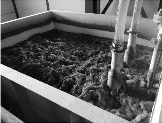
第6図 膜分離槽内 (SS※ = 2700mg/L) 条件下での浸漬型膜ろ過の実験例
