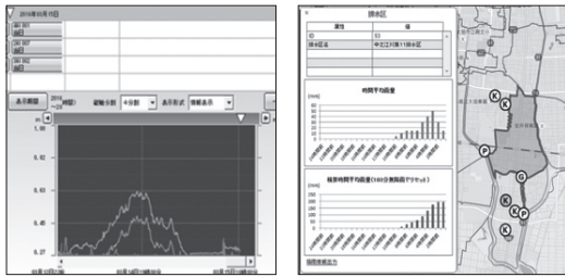
管路内水位の推移グラフ表示 過去24時間の降雨量・積算雨量の推移グラフ表示 (現況と予測)
