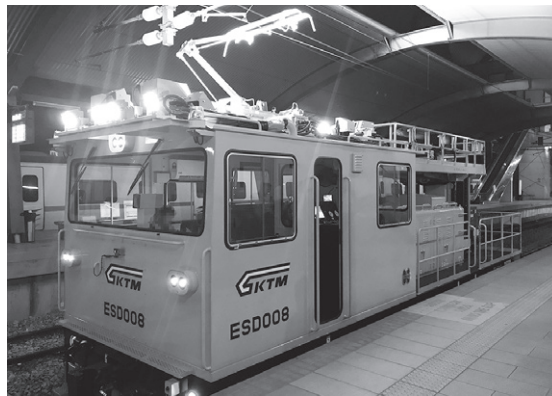
第4図 検測中の架線検測装置
