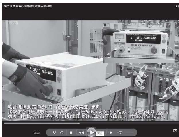
第6図 耐圧試験動画作業手順解説例
