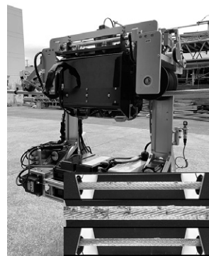
第2図 撮像検査システム (外観と撮影画像)
