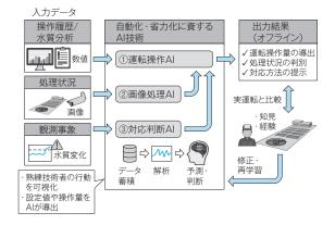
第5図 AIによる下水処理場運転操作導出技術のイメージ
