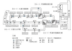
第2図 置戸町流雪溝設備概要
