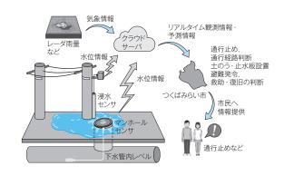
第9図 洪水・浸水対策支援サービス実証試験
