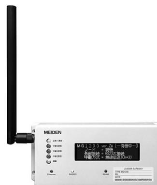
第 2 図 PLCローダ用長距離中継装置（MG1200）
