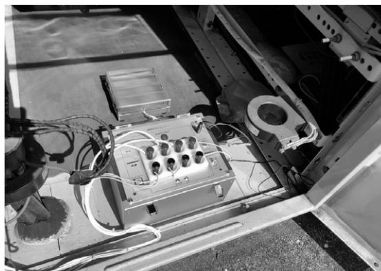
第 1 図 電気絶縁汚損劣化トレンドセンサの設置状況
