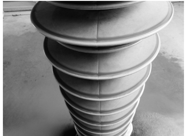
第 1 図 供試器汚損時の外被表面状態
