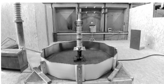
第4図 小電流放電試験状況
