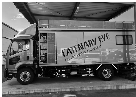
第7図 CATENARY EYEを搭載した軌陸車
