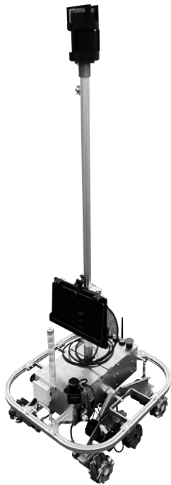
第 1 図 巡視点検向け四次試作機
